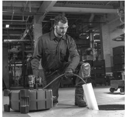
Figuur 5 – Voorbeeld van een verlenging van de afvoeropening tot minder dan 3' van de veeruitvoer van de machine
