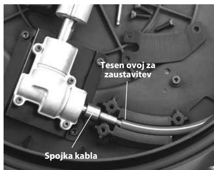
Slika 12 - Zamenjava sklopa kabla
