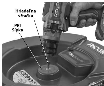
Obrázok 4 – Pripievanie vrtáčky k hriadeľu na vrtáčku
