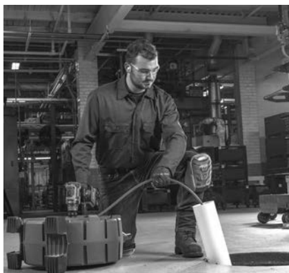
Slika 5 - Primer podaljšanja dostopa do odtoka 3' odprtine za kabla na napravi
