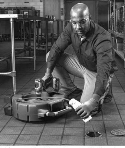
Şekil 10 – Kablo Kılıfına Yağlama Maddesi Uygulama
