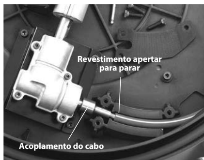
Figura 12 – Substituir o conjunto do cabo
