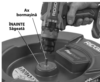
Figura 4 – fixarea bormașinii pe axul acesteia
