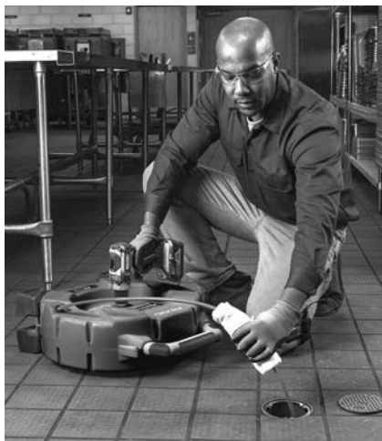
Rysunek 10 – Nakładanie środka smarnego na osłonę wałka giętkiego
