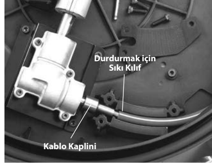
Şekil 12 – Kablo Grubunun Değiştirilmesi
