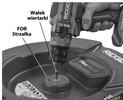
Rysunek 4 – Mocowanie wiertarki na wale wiertarki
