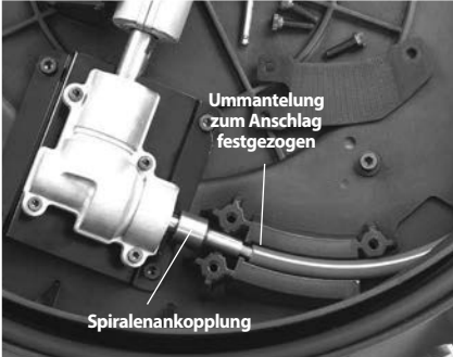
Abbildung 12 – Wechseln der Spirale
