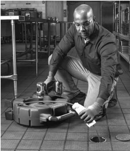
Abbildung 10 – Auftragen von Schmiermittel auf die Spiralenummantelung
