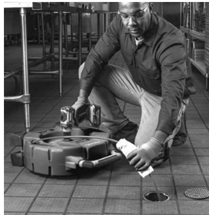
10. Ábra – Kenőanyag felvitele a kábelköpenyre
