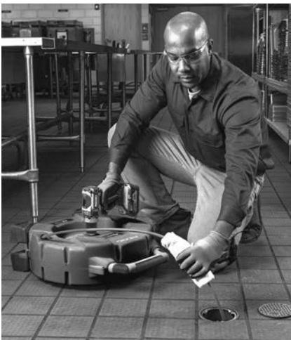
Figuur 10 – Smeermiddel aanbrengen op de veermantel
