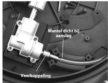
Figuur 12 – Veereenheid vervangen
