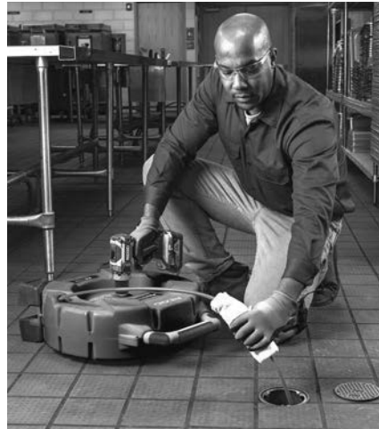
Figura 10 – Applicazioni di lubrificante nella Guaina del cavo
