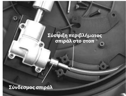
Εικόνα 12 – Αλλαγή του συγκροτήματος σπирάλ
