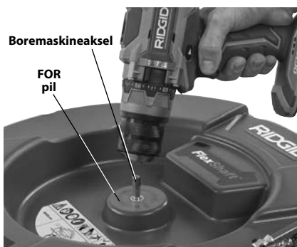
Figur 4 – Påsætning af boremaskine på boremaskineaksel
