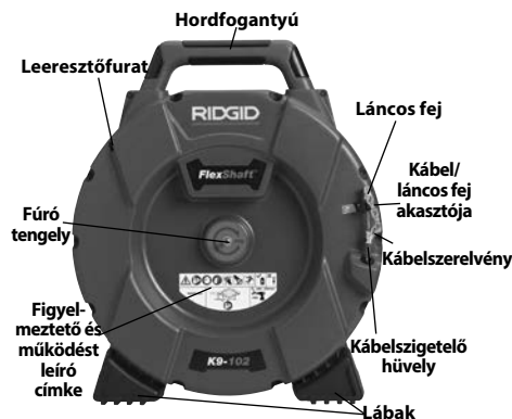
1A Ábra – RIDGID® FlexShaft lefolyótisztító gép
