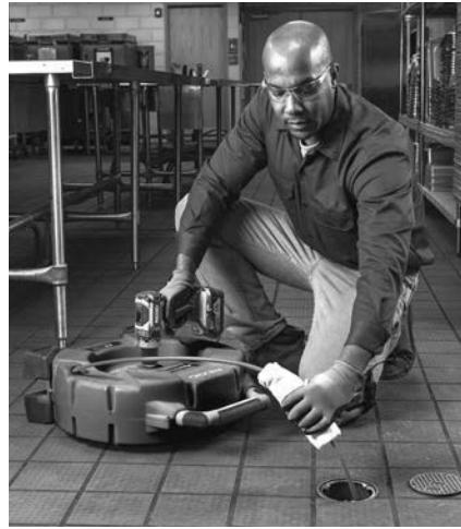
Εικόνα 10 – Εφαρμογή λιπαντικού στο περίβλημα σπирάλ
