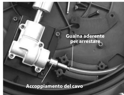
Figura 12 – Sostituzione del Gruppo del cavo
