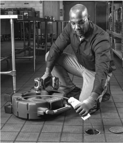
Slika 10 – Nanošenje maziva na oblogu sajle
