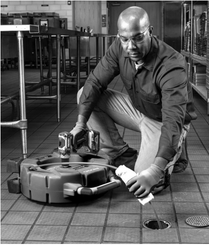
图 10 – 向钢索护套管涂抹润滑剂
