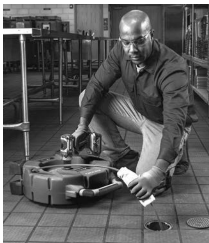
Figur 10 – Applicera smörjmedel på spiralhöljet
