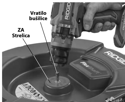
Slika 4 – Postavljanje bušilice na vrtilo
