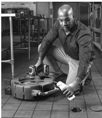
Figura 10 – Aplicar lubrificante ao revestimento do cabo
