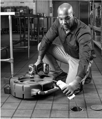
그림 10 - 윤활유를 케이블 피복에 도포
