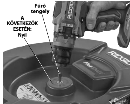
4. Ábra – A fúrógép csatlakoztatása a fúró tengelyhez
