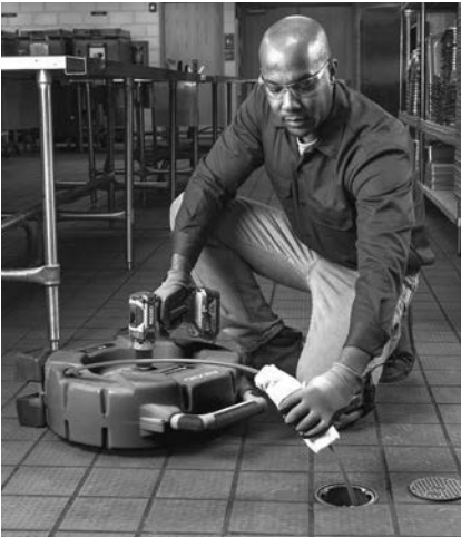
Slika 10 – Nanošenje maziva na izolaciju sajle
