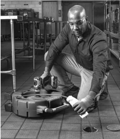
Рис. 10 - Нанесение смазки на оболочку троса
