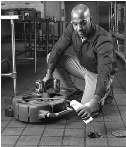
Obrázek 10 – Aplikace maziva na kabelové pouzdro
