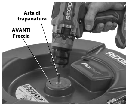
Figura 4 – Collegamento del trapano all'asta di trapanatura
