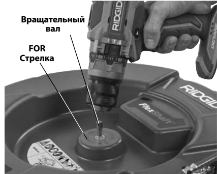
Рис. 4 - Крепление дрели к вращательному валу
