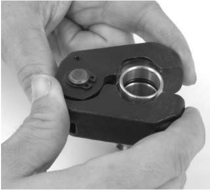
Рис. 9 – Установка обжимного кольца на фитинг
