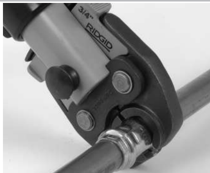
Рис. 7 – Установка пресс-клещей ножничного типа вокруг фитинга
