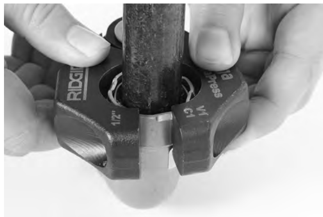
Рис. 11 – Установка обжимного кольца на фитинг
