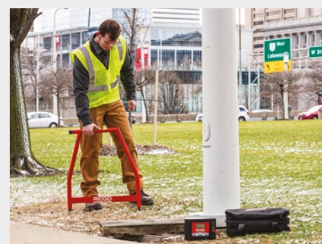
Стандартное оборудование: А-рамка FR-30, передатчик FT-103, заземляющий стержень, красный и черный проверочные концы, сумки, батарейки, инструкции по эксплуатации.
